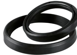
Essa junta elástica possui um sistema de fixação em polipropileno, que auxilia o posicionamento do anel na bolsa dos tubos Amanco Biax, aumentando sua resistência à extrusão sob pressão e impedindo seu deslocamento no transporte, manuseio e instalação.
