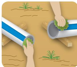
b) Realizar um calço nos tubos para evitar a entrada de corpos estranhos nas bolsas e nas pontas durante a execução da junta.
