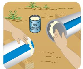
f) Introduzir a ponta do tubo até o fundo da bolsa e depois recuá-la observando as marcações na ponta do tubo, para permitir pequenos movimentos da tubulação devido à dilatação dos tubos e recalques do terreno.
