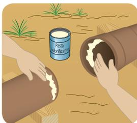
e) Introduzir a ponta do tubo até o fundo da bolsa e depois recuá-la em aproximadamente 1 cm para permitir pequenos movimentos da tubulação, devido à dilatação dos tubos e recalques do terreno.
