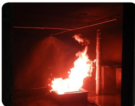
b) Ensaio dos corpos de prova com abertura de um sprinkler.
