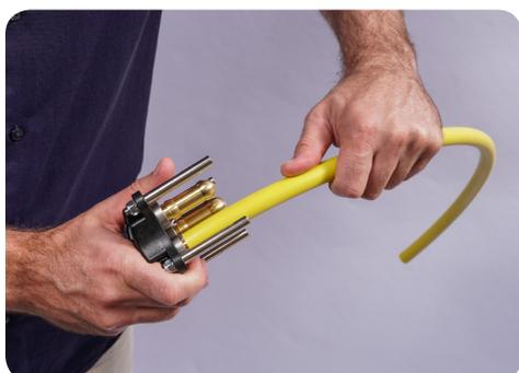
**c) Inserção da conexão:** insira a conexão no tubo até o ponto máximo, verificando o posicionamento através das aberturas presentes no anel de plástico.
