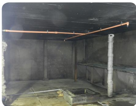
a) Corpo de prova instalado no forno da câmara de ensaios antes de iniciar o ensaio de exposição ao fogo com baixa pressão de fluxo.
