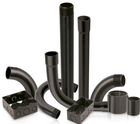
O sistema é composto por eletrodutos de PVC na cor preta, com comprimento comercial de 3 metros, nos diâmetros referenciais de 1/2", 3/4", 1", 1 1/4", 1 1/2", 2", 2 1/2", 3" e 4", roscáveis; e 20, 25 e 32 mm para eletrodutos soldáveis.
