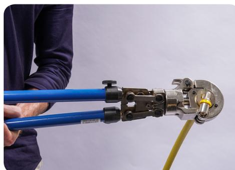
**e) Conclusão da instalação:** retire a prensa, abrindo as garras, ou abra o alicate e a conexão estará pronta.
