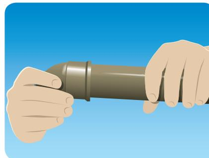
**e)** Remover o excesso de Adesivo Plástico PVC e deixar secar. Aguardar uma hora para liberar o fluxo de água e 12 horas para submeter a tubulação à pressão.
