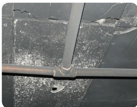
d) Corpo de prova após término de exposição ao fogo com baixa pressão de fluxo.
