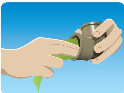
**b)** Limpar as superfícies lixadas com Solução Preparadora, eliminando as impurezas que podem impedir a ação do Adesivo Plástico PVC. Esta ação prepara o PVC para a soldagem.
