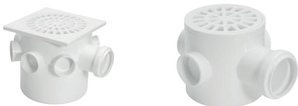
O formato cilíndrico da caixa sifonada permite entradas por qualquer ângulo. Existem caixas com 3, 5 ou 7 entradas. Para esgoto secundário com diâmetro de saída DN 40 e para esgoto primário com diâmetros de saída DN 50 e DN 75, com bolsa de dupla atuação.
