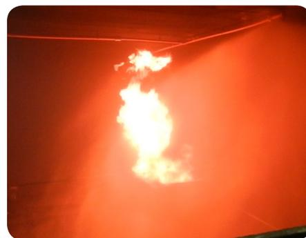
c) Ensaio dos corpos de prova com abertura do segundo sprinkler.
