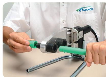
h) Após retirar o tubo e a conexão do termofusor, introduza imediatamente a ponta do tubo na bolsa da conexão até o anel da conexão formado pelo aquecimento, respeitando o intervalo para acoplamento da tabela de tempo de termofusão.
