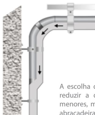
A escolha de Amanco QuickStream significa reduzir a quantidade de tubos, diâmetros menores, menos bocais no telhado e menos abraçadeiras para fixação do sistema.
